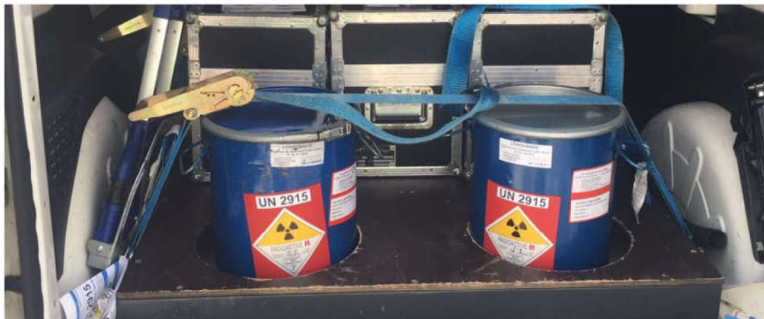
Obrázok 9 Príklad prepravy zásielky rádiofarmák kategorizovanej ako UN 2915
