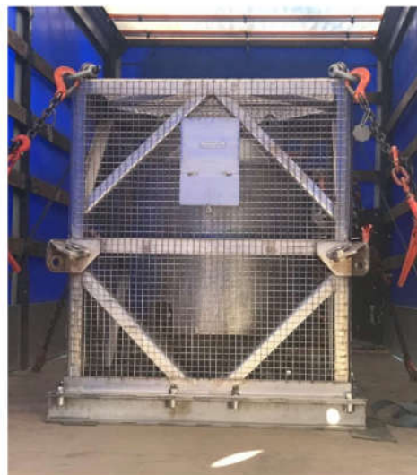
Obrázok 11 Príklad prepravy vysokoaktívnych žiaričov kategorizovaných ako UN 2916
