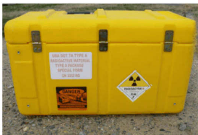
Obrázok 10 Príklad prepravy zariadenia TROXLER kategorizovaného ako UN 2915
