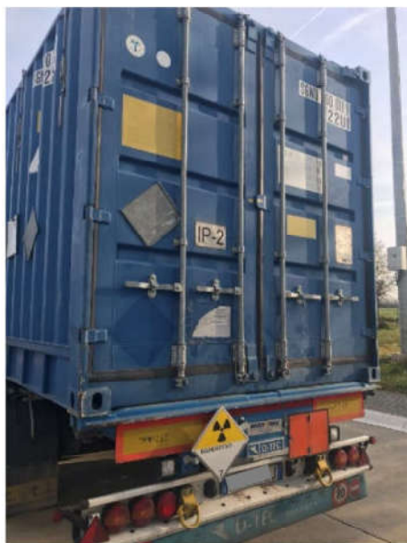
Obrázok 7 Príklad prepravy zásielky kategorizovanej ako UN 2912
