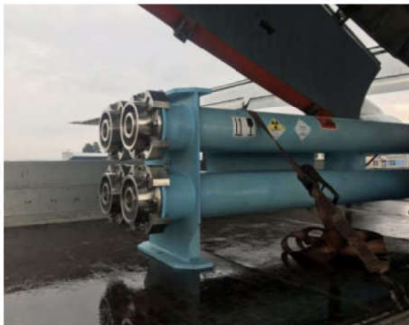
Obrázok 12 Príklad prepravy štiepných materiálov kategorizovaných ako UN 3328
