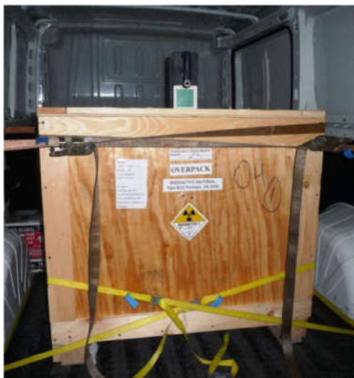
Obrázok 11 Príklad prepravy vysokoaktívnych žiaričov kategorizovaných ako UN 2916
