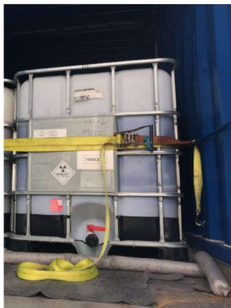
Obrázok 7 Príklad prepravy zásielky kategorizovanej ako UN 2912
