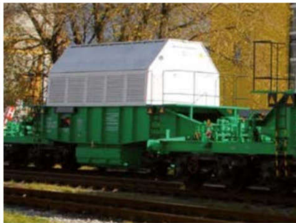
Obrázok 12 Príklad prepravy štiepných materiálov kategorizovaných ako UN 3328
