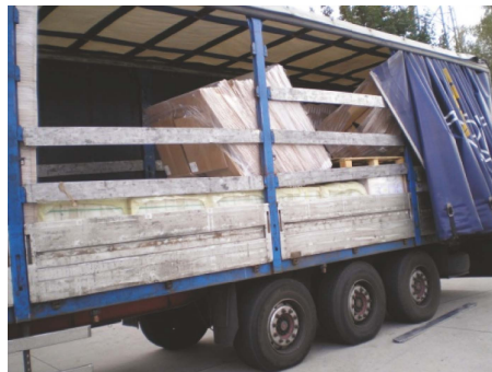
Obr. 19: Nedostatočné zabezpečenie nákladu iba pružnou obalovou fóliou
