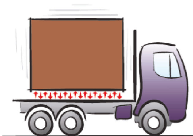
Obr. 3: Zvislé vibrácie počas jazdy
