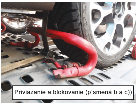
Obr. 58: Opatrenia na zabezpečenie prepravy osobných automobilov
