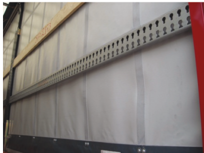
Obr. 27: Hliníková lišta s otvormi na upevnenie blokovacích tyčí
