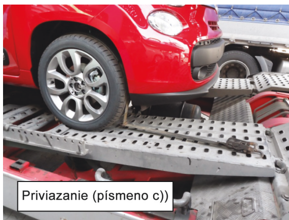
Obr. 57: Opatrenia na zabezpečenie prepravy automobilov
