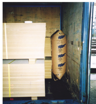
Obr. 29: Vzduchový vankúš na bočné blokovanie
