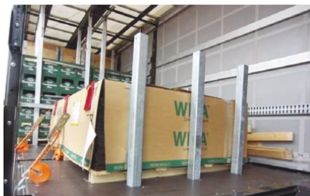
Obr. 7: Stĺpiky používané na blokovanie v smere dopredu
