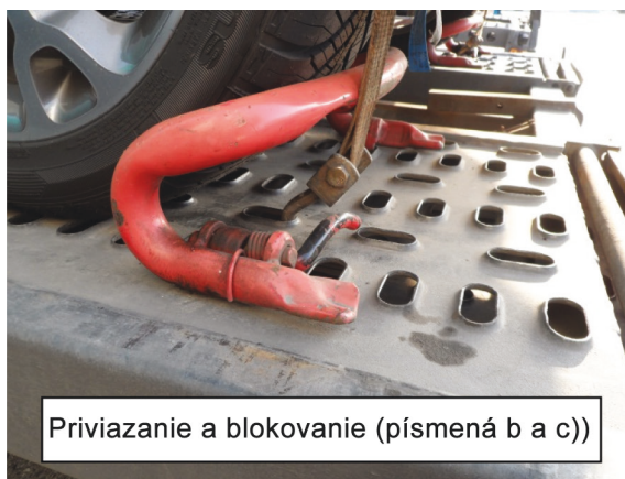
Obr. 58: Opatrenia na zabezpečenie prepravy osobných automobilov
