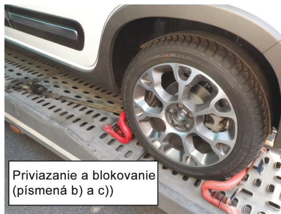
Obr. 57: Opatrenia na zabezpečenie prepravy automobilov
