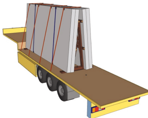
Obr. 48: Zabezpečenie nákladu kombináciou blokovania, konštrukcie v tvare písmena A, obviazania a viazania ponad náklad
