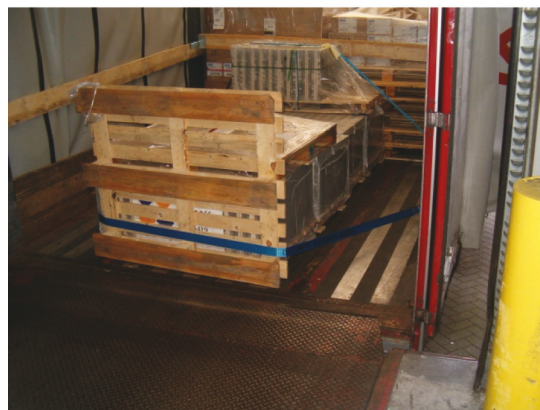
Obr. 75: Pripevnenie zmiešaného nákladu odzad
