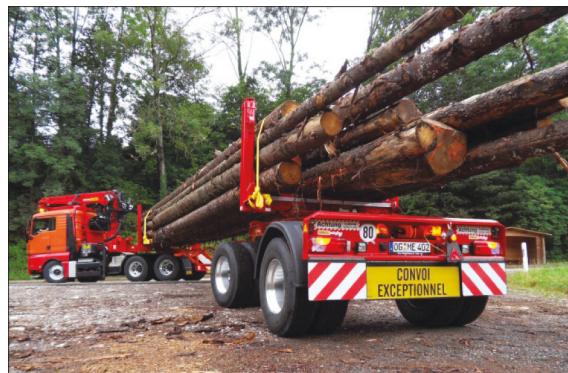
Obr. 54: Zabezpečenie celých stromov
