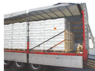
Obr. 39: Priviazanie pružinami s použitím paliet
