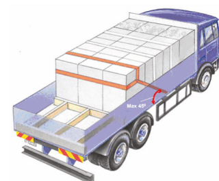
Obr. 40: Priviazanie pružinami s použitím závesu
