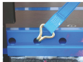
Obr. 13: Ukotvovací otvor v bočnom profile
