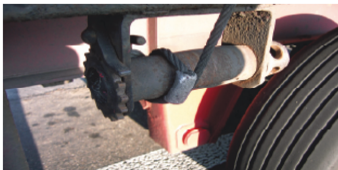
Obr. 24: Oceľové lano napínané navijakom
