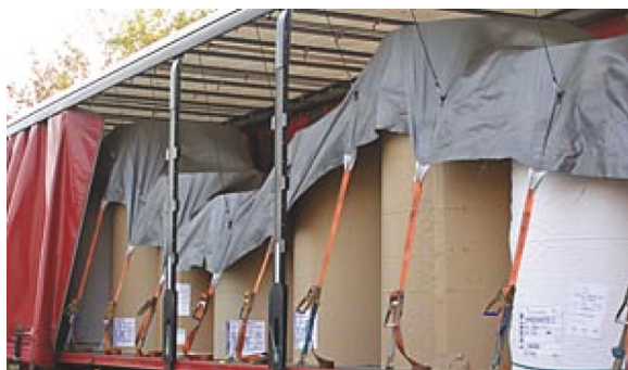
Obr. 31: Zabezpečenie pomocou prikrývky
