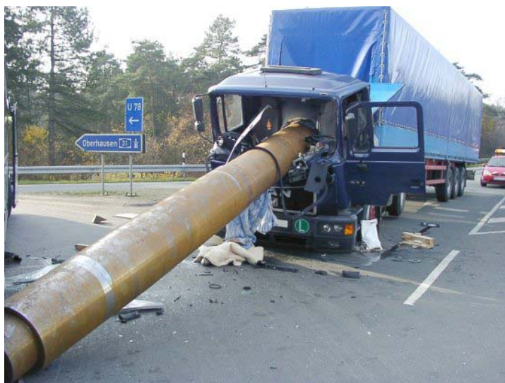
Obrázok 1: Pri prudkom brzdení nesprávne zabezpečené oceľové rúry prerazili predné čelo a vodičovú kabínu.
