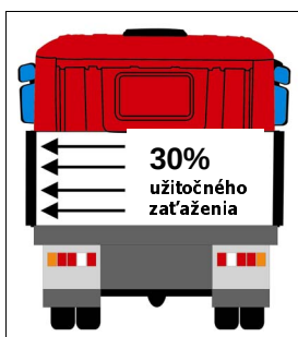
Obrázok 28: Požiadavky na pevnosť bočníc
