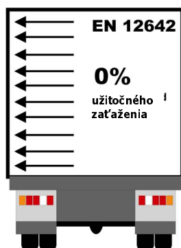
Obrázok 612: Požiadavky na pevnosť plachiet bočníc
