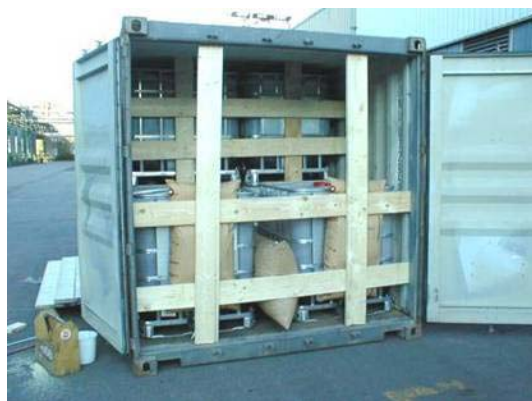
Obrázok 90: Stredne veľké kontajnery (SVK) uložené na sebe v kontajneri
