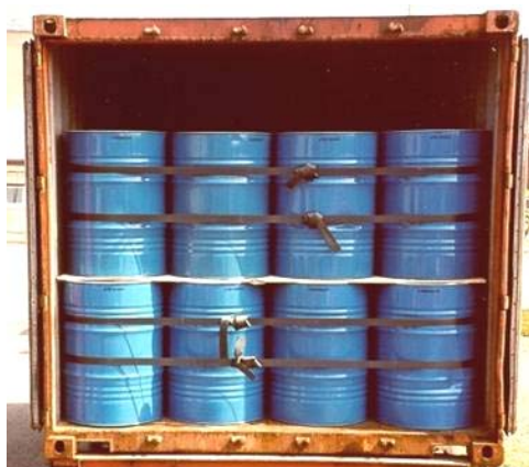
Obrázok 89: Uvoľnené sudy uložené na sebe v kontajneri, dve vrstvy štyroch radov
