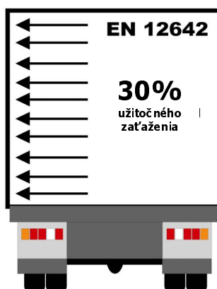
Obrázok 410: Požiadavky na pevnosť bočníc pri skriňových karosériách
