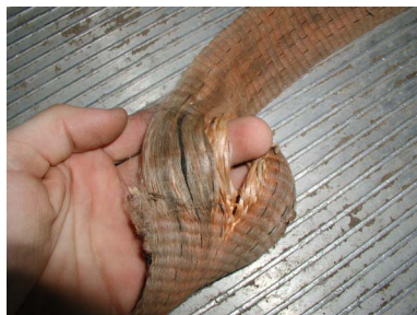
Obrázok 36: Vážne poškodená popruhovú tkanina? Odhodte ju do koša!
