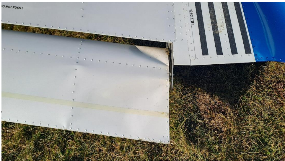
Obr. č. 5 Detail na poškodenie ľavej vztlakovej klapky
