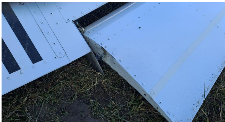
Obr. č. 6 Poškodenie pravej vztlakovej klapky
