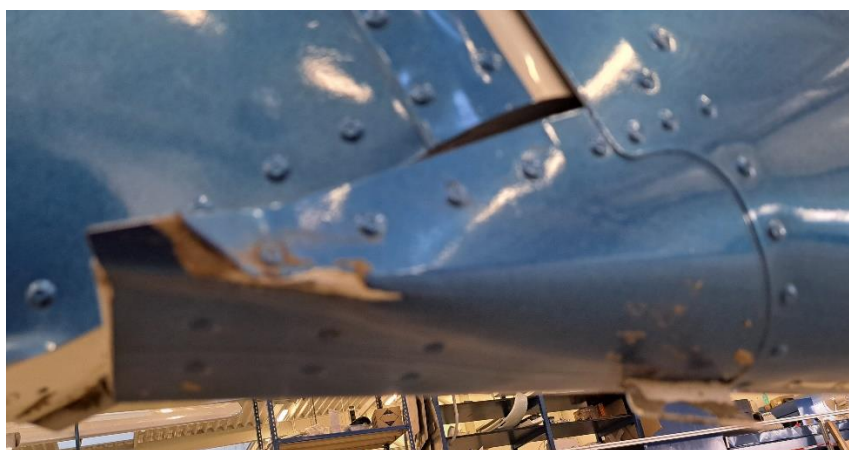
Obr. č. 8 detail na poškodenia spodnej časti segmentu ukončenia trupu
