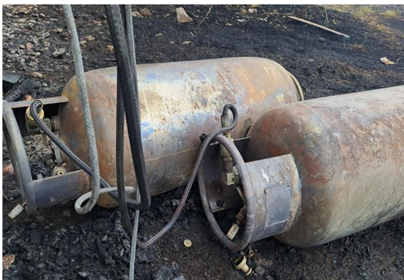
Obr. č. 2. Poškodenie príslušenstva balóna
