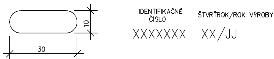
Obrázok 24 – Identifikačná značka výrobcu UNIPROMET, v [mm]
