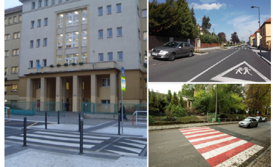
Obr. 26. Priechod pre chodcov pred školou umiestnený na dlhom priečnom prahu v spojení so zúžením vozovky do jedného pruhu, zvýraznenie priechodov pred chodcami pred školami – podfarbený priechod, VDZ „Pozor deti“
