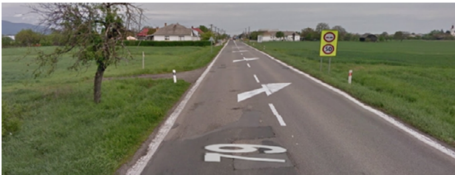
Obr. 28. Predbežné varovanie v podobe značky „Zákaz obiehania“ a max. povolenej rýchlosti na reflexnom podklade
