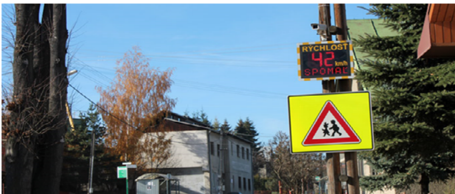
Obr. 30. Informatívny radar ukazujúcu aktuálnu rýchlosť prechádzajúceho vozidla pred školou
