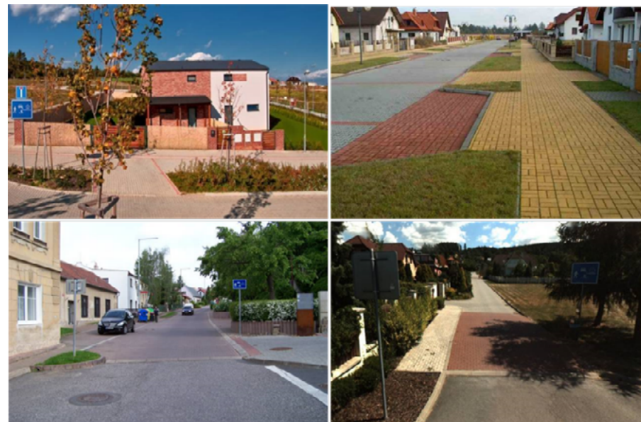
Obr. 54. Prispôsobenie uličného dizajnu v novobudovanej obytnej zóne už v prípravnej fáze pred samotnou výstavbou nehnuteľností a vstup do obytnej zóny vyznačený tak ZDZ ako aj zdôraznený zmenou povrchu a farby vozovky (červená dlažba), resp. dlhým priečnym prahom
