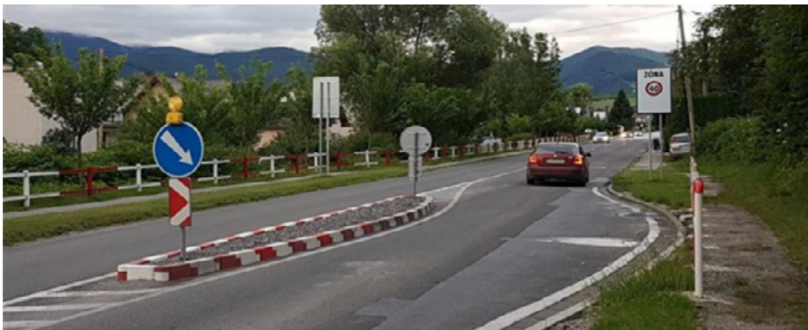
Obr. 35. Zóna 40 v kombinácii s vybočením jazdného pruhu formou deliaceho ostrovčeka (Rosina, SR)
