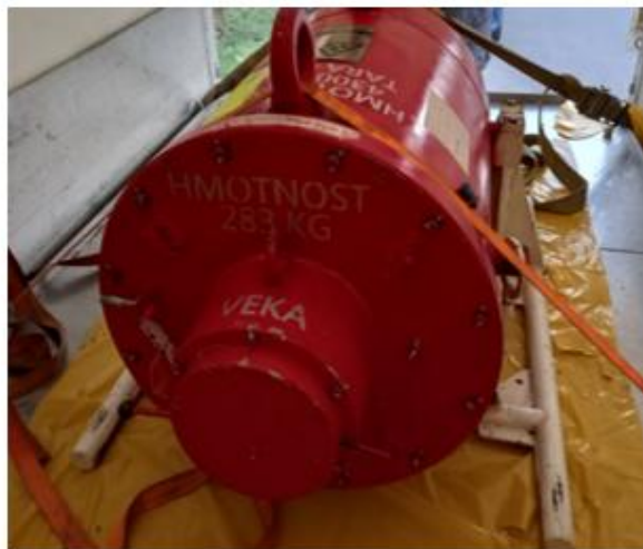
Obrázok 10 Príklad prepravy zásielky rádioaktívneho materiálu podľa osobitnej dohody
