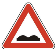
A 5 Nerovnosť vozovky
