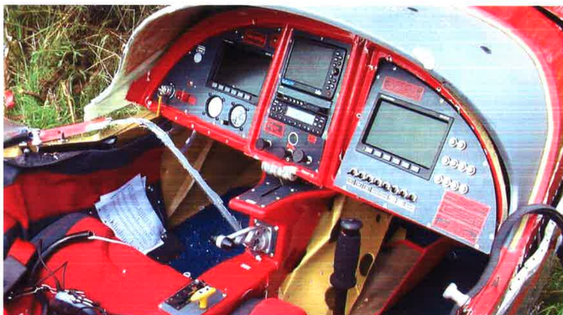
Obr.č. 8 - Detailný pohľad do kabíny lietadla s odlomenou ľavou riadiacou pákou
