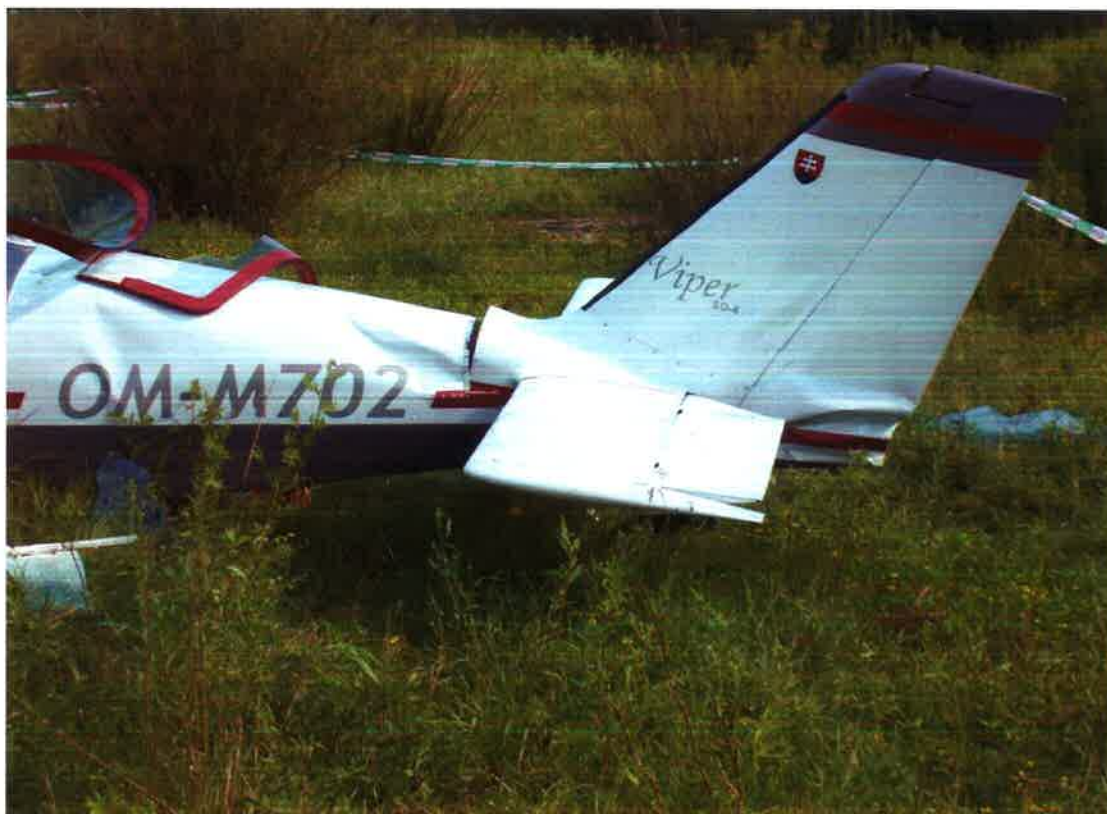
Obr.č. 3 - Detailný pohľad na chvostovú časť lietadla po LN z ľavej strany
