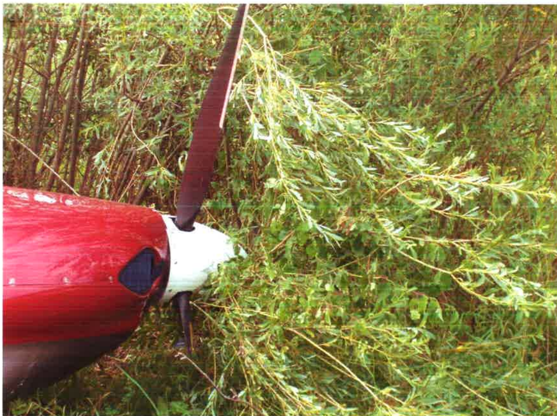
Obr.č. 7 - Detailný pohľad na odlomený list vrtule po leteckej nehode
