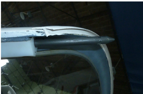
Obr.1 detail vysunutého klinu zámku kabíny v zatvorenej polohe
