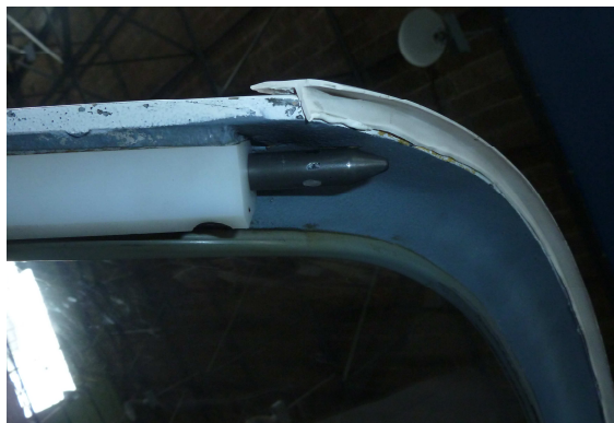
Obr.2 detail zasunutého klinu zámku kabíny v otvorenej polohe
