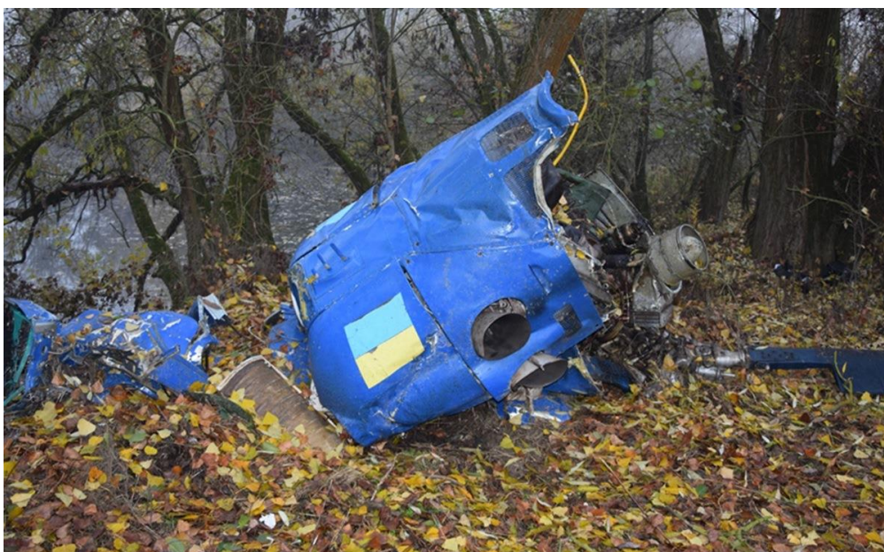
Obr.2 Predná vrchná časť draku s motormi
