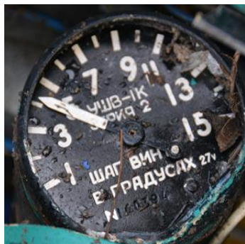
Obr. 11 Uhol nastavenia listov nosného rotora
