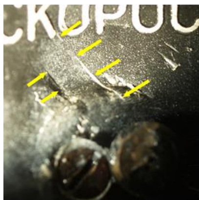
Obr.14 Detailný záber na vtláčky po hranách odlomenej časti ručičky prístroja
