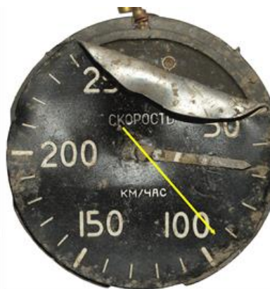
Obr.15 Smerovanie ručičky prístroja v čase vzniku uvedených vtláčkov
