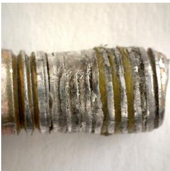
Detailný pohľad na poškodený závit skrutky
