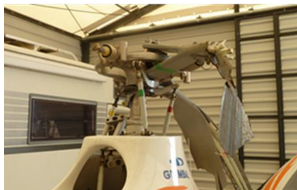
Obr. 1,2 Pri dopade vrtuľníka bol násilne zastavený fenestron a následne od NR i motor
