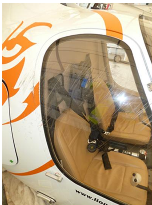
Obr. 3 Pilotná kabína zvnútra nevykazovala známky poškodenia, na pravej strane bola kabína mierne poškodená
