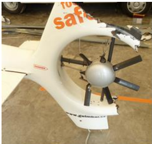
Obr. 1,2 Pri dopade vrtuľníka bol násilne zastavený fenestron a následne od NR i motor
