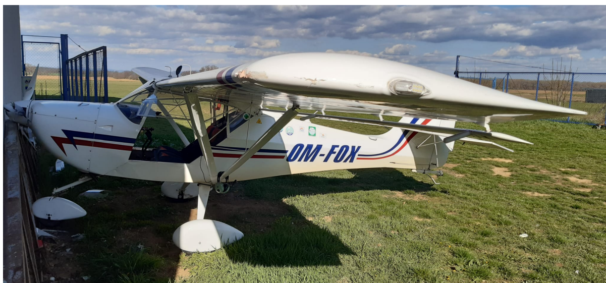
Poškodenie vrtule, nábežnej hrany krídla, uchytenia krídla k trupu
