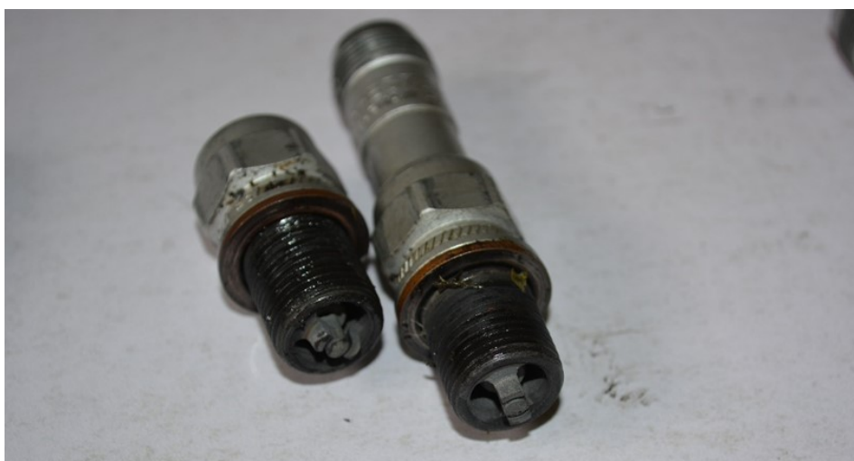
Zapaľovacie sviečky, vľavo chýbajúca časť na pripojenie vodiča
