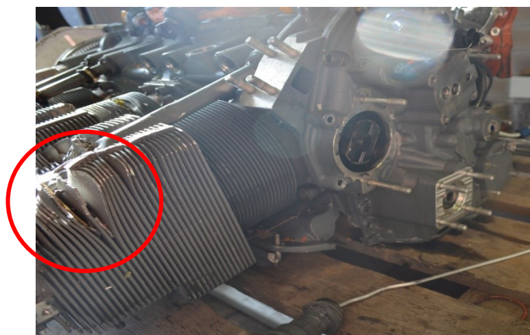
Poškodenie hlavy valca
