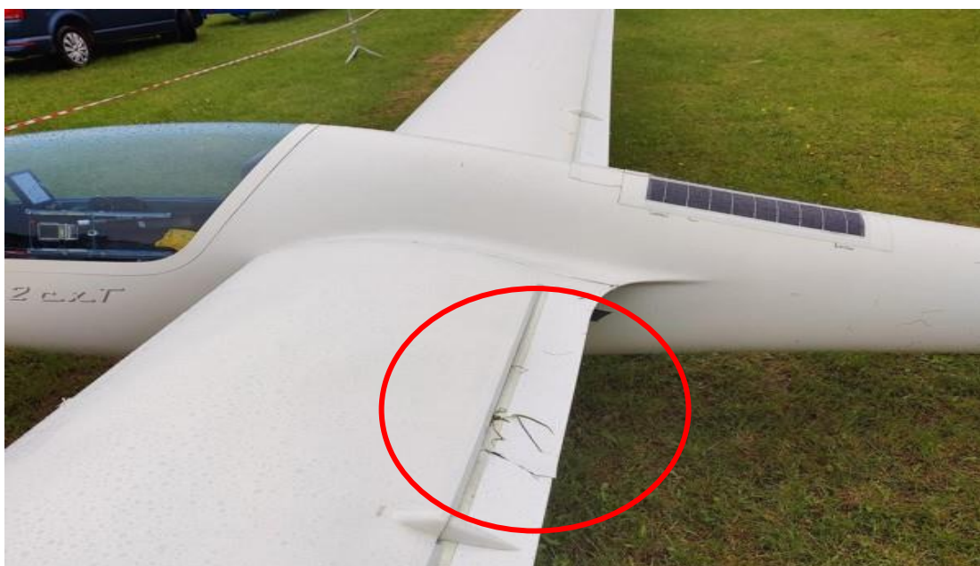
Obr. č. 6 detail na poškodenia vztlakovej klapky
