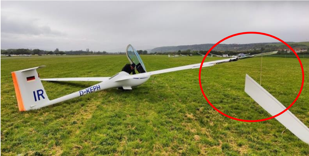
Obr. č. 3 detail na odlomené krídlo
