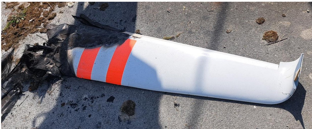
Obr. č. 7 detail na koncovú časť ľavého krídla s ulomeným wingletom
