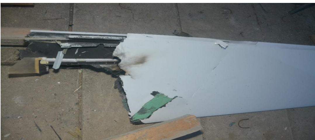
Obr. č. 7 detail na koncovú časť ľavého krídla s ulomeným wingletom
