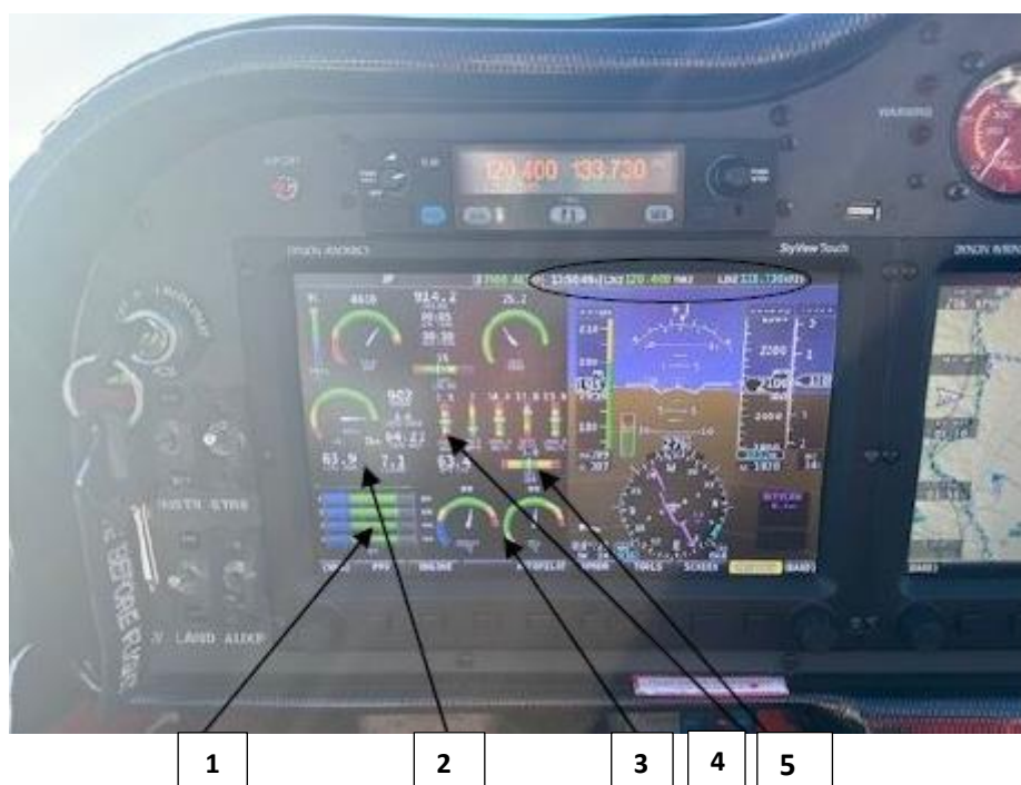
Obr. č. 2 parametre motora 2 minúty pred vznikom incidentu- 1 teplota hláv valcov, 2 množstvo paliva, 3 teplota oleja, 4 tlak oleja, 5 tlak paliva
